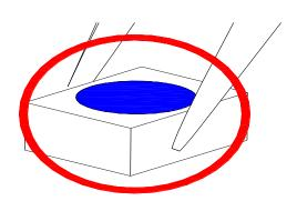
2、不要将焊接好的发光二极管堆叠放置,会导致发光二极管划伤及胶体受损造成死灯。
