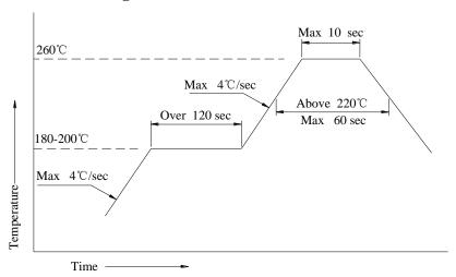
1、 回流焊建议使用免清洗助焊剂,并依照回流焊曲线进行焊接,焊接次数不可超过2次。
