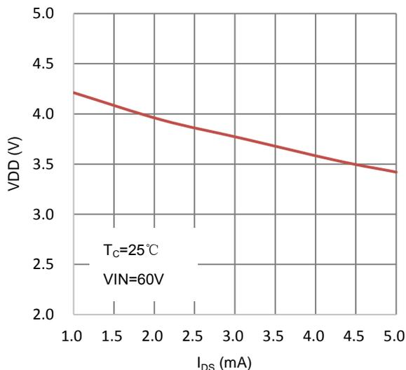
图 3. 实测 VDD 电压值与电流的关系
