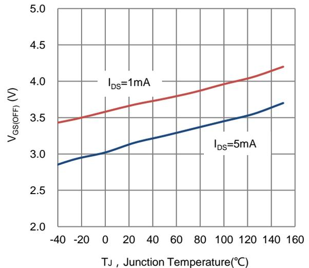
图 4. DMZ1520E 的  $V_{GS(OFF)}$  参数值与结温的关系
