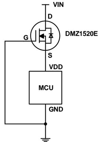
图 2. 使用 DMZ1520E 直接给 MCU 供电的方案
