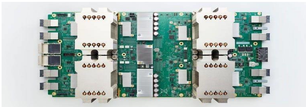
图表 8 搭载谷歌 TPU 芯片的 AI 训练板
